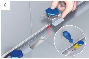
Die Klammern für die Reinigung komplett herausnehmen. Der noch vorhandene Keil kann entsorgt werden. Dieser dient nur zur Fixierung während der Rinnenmontage.
