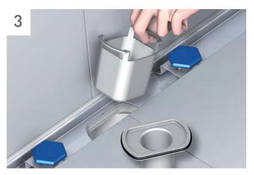
Der Geruchsverschluss muss **unter leichtem Druck** wieder eingesetzt und verschlossen werden. Ansonsten können Kanalgase durch den Abfluss dringen.
