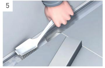
Reinigen Sie die Rinnen-Innenfläche gründlich mit der gelieferten Reinigungsbürste oder einem nicht kratzenden Schwamm (kein SCOTCH verwenden!). Nach der Reinigung die Klammern einsetzen.
