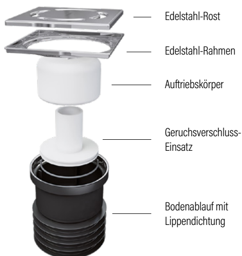
Geruchsverschluss ohne Sperrwasser
