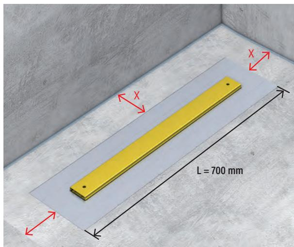
Esempio: larghezza della doccia 900 mm, lunghezza dell'involucro 700 mm, copertura 600 mm Distanza dalla parete  $x = \text{min. } 100 \text{ mm}$
