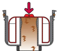
A prova di odori senza acqua di bloccaggio
