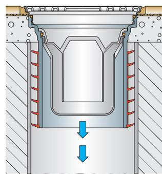
Pronto CNS con telaio in acciaio inox
