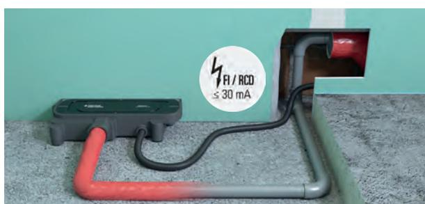
Le corps d'avaloir Connect est homologué VDE. Le raccordement au circuit électrique de 230V, protégé par un fusible de min. 10A (à action retardée) et un disjoncteur de fuite à la terre (30mA), doit être effectué par un électricien qualifié.
