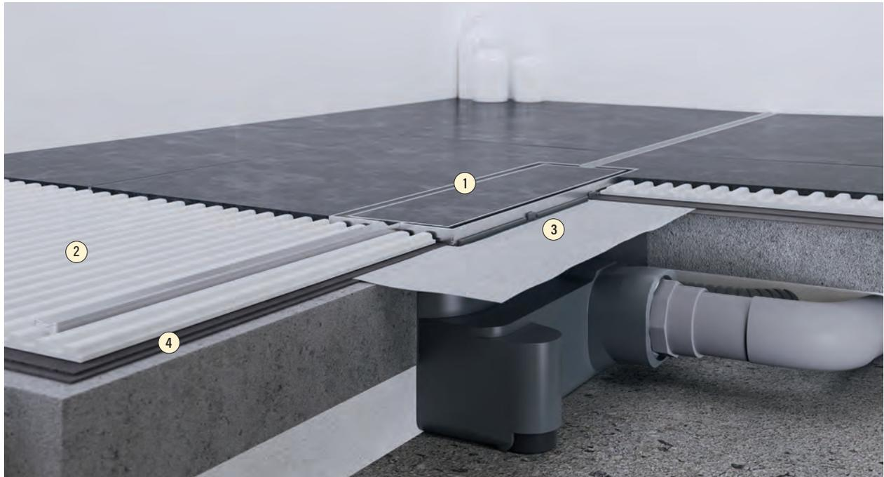
1. Profilé en acier inoxydable avec couvercle à carreler
