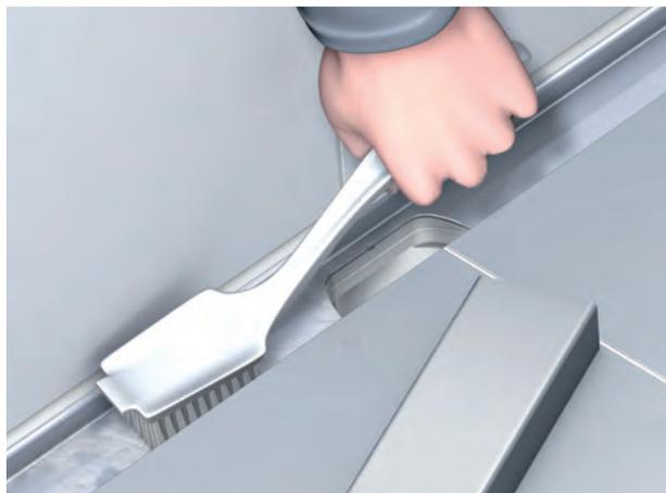
Pulire accuratamente la superficie interna della grondaia con la spazzola in dotazione o con una spugna non graffiante (non usare SCOTCH!). Dopo la pulizia, inserire le clip. Il cuneo rimanente può essere smaltito. Serve solo per fissare il gruppo della grondaia.
