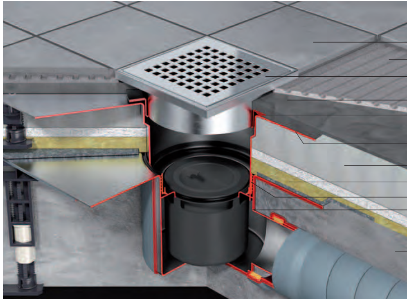
Montage avec revêtement en carreaux (drainage secondaire)
