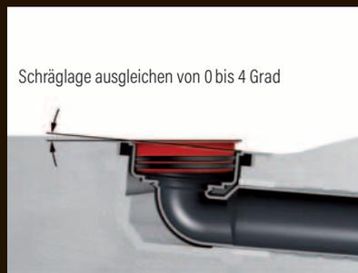
Der SwissUnico-Ausgleichs-Adapter gleicht Schräglagen bis zu 16 mm aus. Die doppelte Lippendichtung sorgt dabei für festen Halt des Adapters im Ablaufgehäuse.
