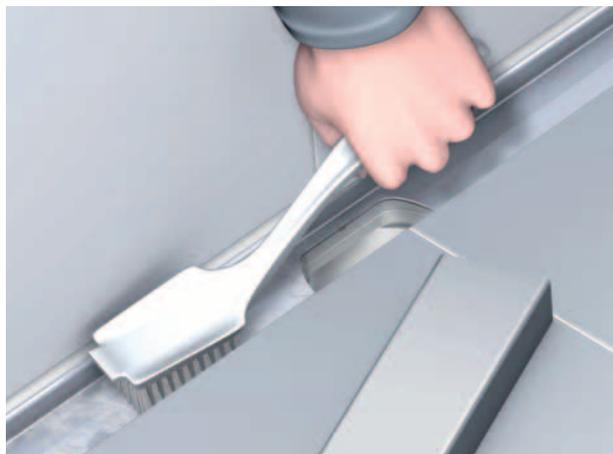
Reinigen Sie die Rinnen-Innenfläche gründlich mit der gelieferten Reinigungsbürste oder einem nicht kratzenden Schwamm (**kein SCOTCH verwenden!**). Nach der Reinigung die Klammern einsetzen. Der noch vorhandene Keil kann entsorgt werden. Dieser dient nur zur Fixierung der Rinnenmontage.
