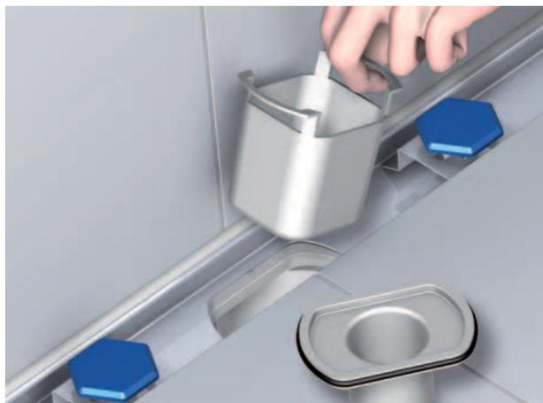
Der Geruchsverschluss muss unter leichtem Druck wieder eingesetzt und verschlossen werden. Ansonsten können Kanalgase durch den Abfluss dringen.
