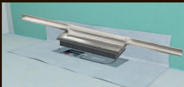
Durch eine einklickbare Dichtmanschette wird das Ablaufgehäuse Connect in die Verbundabdichtung eingebunden. Der Plattenleger montiert die Duschrinne und vollendet das Werk.
