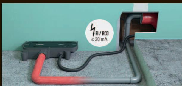
Das Ablaufgehäuse Connect hat eine VDE-Zulassung. Der Anschluss an den mit min. 10 A (träge) und einem FI-Schutzschalter (30 mA) abgesicherten 230V-Stromkreis erfolgt durch eine Elektrofachkraft.
