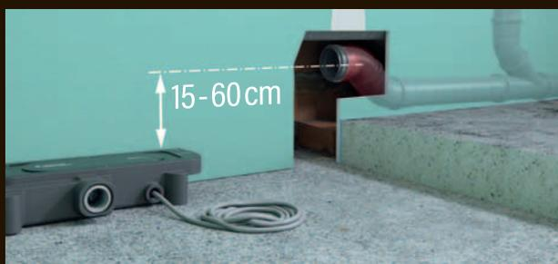
Das Ablaufgehäuse Connect kann ab einem Bodenaufbau von 75 mm eingesetzt werden und Höhenunterschiede von min. 15 cm bis max. 60 cm überwinden.
