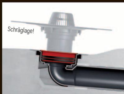
Bei einem schräg einbetonierten Ablaufgehäuse (passiert öfter als man denkt) steht natürlich auch das Aufstockelement in Schräglage.
