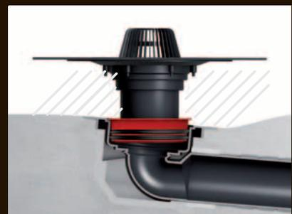
Das Aufstockelement kann jetzt senkrecht in das Ablaufgehäuse gesteckt und plan an die Abdichtungsschicht angebunden werden.
