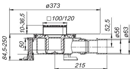
Gruppo completo DallDrain Select: scarico a pavimento con copripiletta Select, griglia e telaio in acciaio inossidabile 1.4301, incluso tappetino insonorizzante
