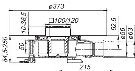
Gruppo completo DallDrain Pure: scarico a pavimento con copripiletta Pure, griglia in acciaio inossidabile 1.4301, telaio in ABS, incluso tappetino insonorizzante
